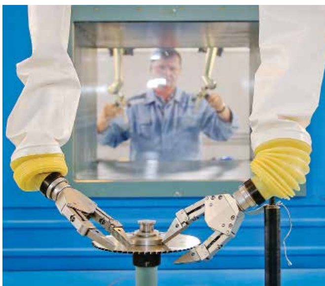
Тренажер копирующего манипулятора. Замена фрезы
